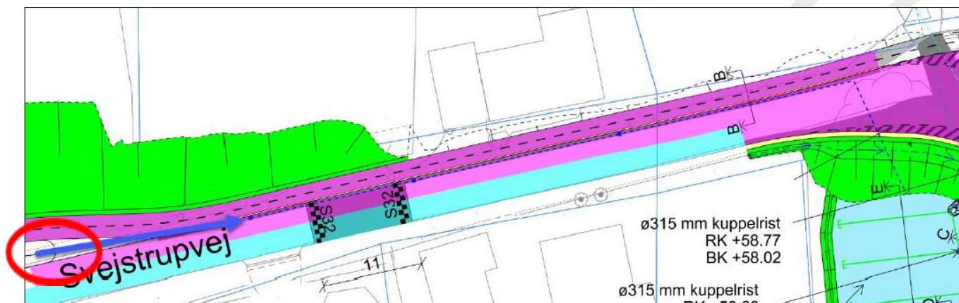
Figur 2. Blå pil angiver rendestensbrønd, og stiplede blå linje angiver regnvandsledningen der fører til regnbedet. Rød cirkel angiver nedsivningstrugets sydøstligste ende.
